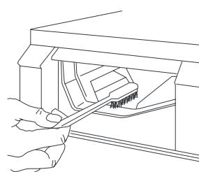
С течением времени моющее средство может также образовывать отложения в нише для дозатора. Удалите отложения старой зубной щеткой.
